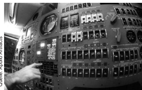
Hauptbedienpanel im Apollo Command Modul mit dem Bediengerät DSKY für den On board Computer. Solch ein Gerät ist u.a. auch an unseren Veranstaltungen in der Sternwarte zu sehen.
