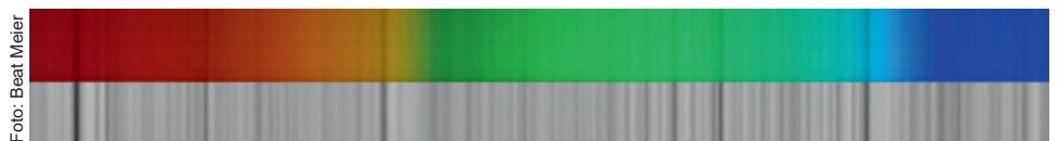
Sonnenspektrum, aufgenommen mit meinem DADOS Spalt-Spektrographen. Rohspektrum (oben, farbig) und verarbeitet (unten, s/w) mit den gut erkennbaren Fraunhoferlinien. Das Spektrum verläuft von grossen Wellenlängen (links, rot) zu kurzen Wellenlängen (rechts blau). Jedes Element auf der Sonnenoberfläche erzeugt ein charakteristisches Linienmuster. Die starke Linie ganz links ist die H-Alpha Linie des Wasserstoffs.
